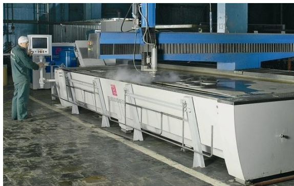
Станок гидроабразивной резки WSS 6020/1HD/37/1A (Австрия) -высококачественная гидроабразивная резка заготовок из металла, стекла, камня, других материалов
