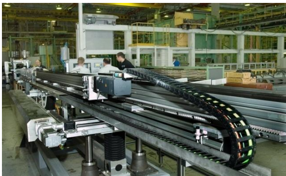
Автоматический станд сборки пучков твэлов для реактора ВВЭР-1000.
