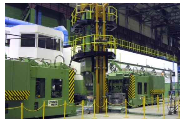
Ковочный комплекс OLF-12МН фирмы SMS Meer. Дляковки штанг из слитков сплавов циркония.
