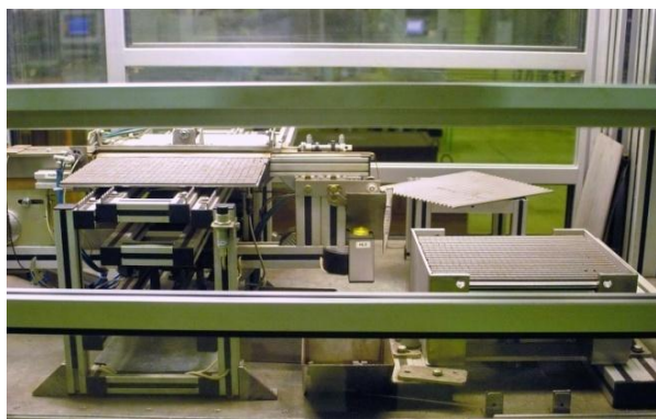
Снаряжение твэлов топливными таблетками С-Паллет.
